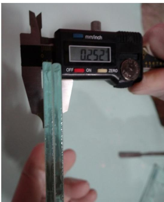
**Figura 3** – Paquímetro digital conferindo espessura das placas com cimento interposto
